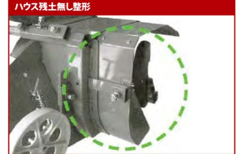
内盛方式によるハウス残土無しうね整形ができます。平高・平うね整形と同時に広幅の溝整形(残土無し)ができ、能率が上がります。支柱際の片寄せもできます。通路の土をさらってしまうため、同時マルチ作業はできません。
