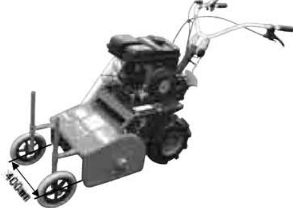
⑤ ハンマーナイフが磨耗すると、切れ味が低下すると同時に余計な動力が必要になりますし、作業能率も低下しますので、早めにドラムの左右振替又は、新しいハンマーナイフに交換してください。
