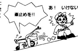
**ロータリ作業や車軸作業では機械の飛び出し(ダッシング)に注意**
