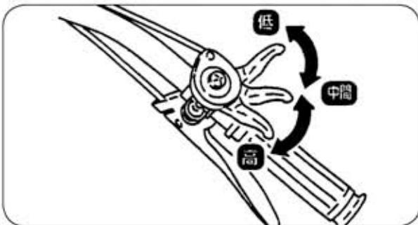
⑤チョークレバーを手元に引くと気化器のチョーク弁が【閉】、押し込むと【全開】になります。
