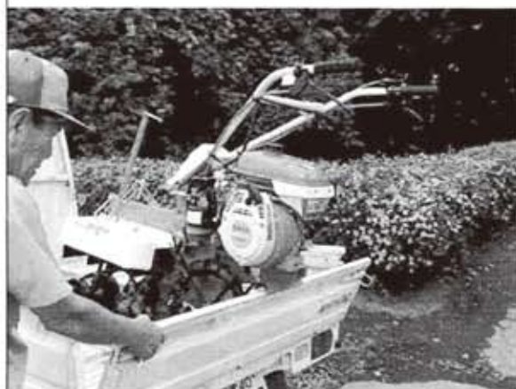
②エンジン下部のU字フックにドアを掛けて後部ドアを閉めてロックしてください。
