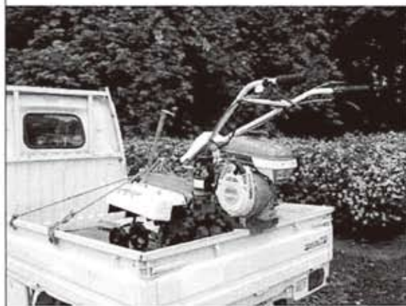
③前輪調節ハンドルにロープでしっかりと固定してください。
